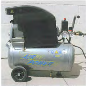
A sűrített levegő hajtja a pneumatikus kézi szerszámokat.
