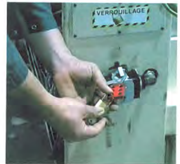
A lelakatolás szükséges, hogy teljes biztonságban tudjunk dolgozni a gépeken.
